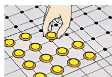
5. ติดตั้งหมุดลงบนรู ที่ทากาวไว้ก่อนที่ทาว จะแห้ง
